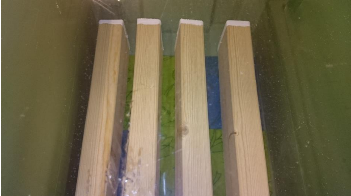
Figur 55 Fotografi som visar träreglar i klimatlåda med magnesiumkloridlösning.
