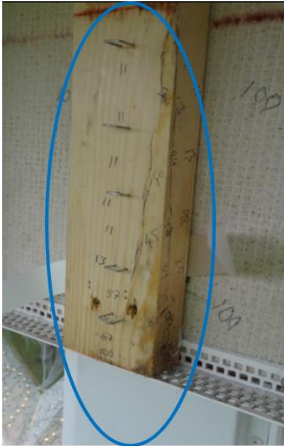
Figur 48 Träregel i luftspalt som uppfuktats från ändträet som ligger an mot plastprofilen
