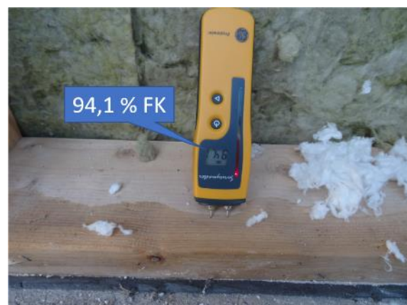
Figur 53 Mätvärde (94,1 % FK) på den opåverkade delen av syllen, precis bredvid gränsen.
