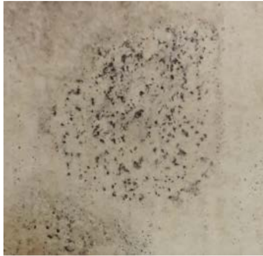
Figur 29 Detaljförstoring av mögelart som bildar ett prickigt mönster på MgO-skivan.
