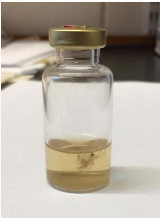
Figur 30 En koloni av mikrobiell växt som har uppstått i saltvätskan som samlats upp från en MgO-skiva.
