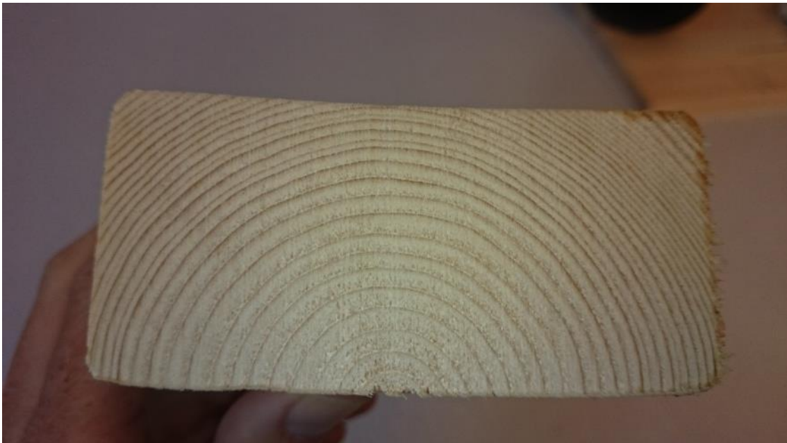
Figur 57 Träregel avsågad, notera "fransarna" spånflisorna på höger sida.
