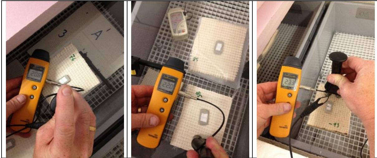
Figur 9 Bilden till vänster visar ytkontaktmätning 20,8 % fuktkvot för skivor som konditionerats vid 75 % RF. I mitten 22,0 % fuktkvot för skivor konditionerade vid 86 % RF samt till höger 23,3 % fuktkvot för skivor som konditionerats vid 93 % RF.
