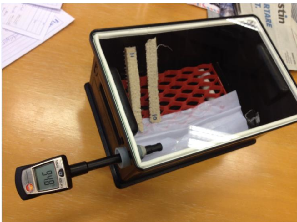
Figur 17 Klimatbox med två remsor av MgO-skiva som ingick i studien.
