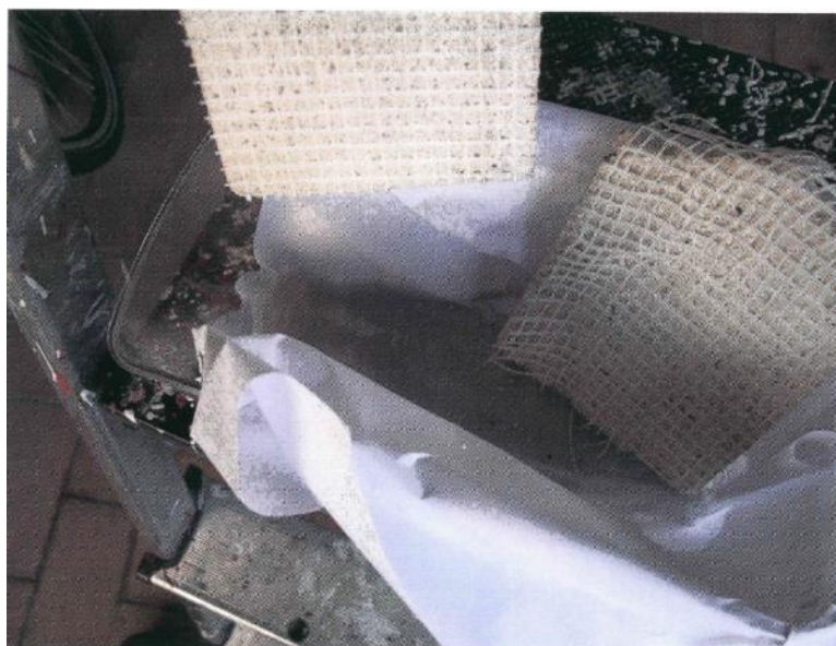
Figur 11 Vätska som utsöndrats från MgO-skiva efter 20 dygns exponering mot uteklimat (utan regn) vintertid i Skåne.
