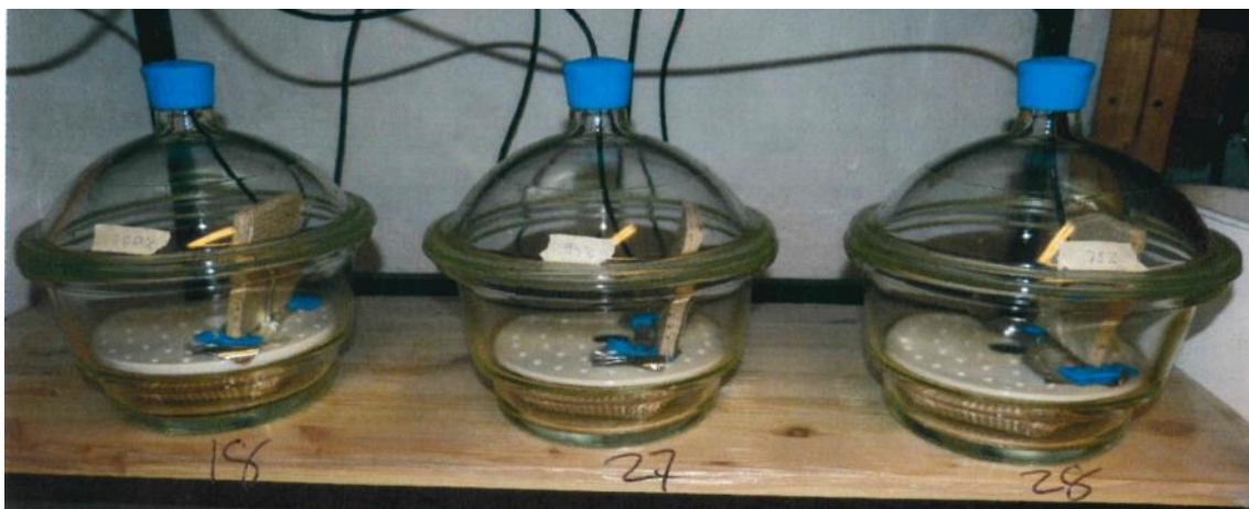
Figur 14 Exsickatorerna med saltlösningar, natriumklorid NaCl (75% RF), kaliumnitrat KNO 3 (95% RF) och avjoniserat vatten H 2 O (100% RF).
