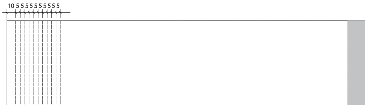
Figur 56 Princip för hur träregeln sågades upp i tunna skivor.
