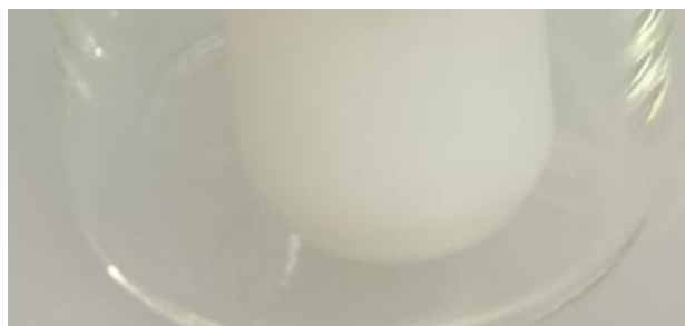
Figur 6 Provrör med vätska från provrör med krossad MgO-skiva med en utfällning (vit) av AgCl 2 .
