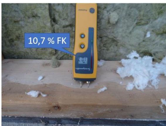
Figur 52 Mätvärde (10,7 % FK) på den opåverkade delen av syllen, strax intill påverkat område.
