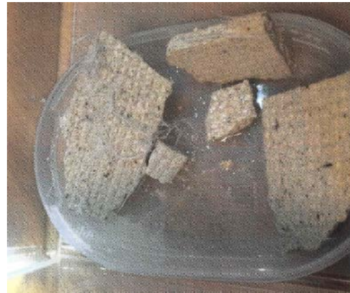
Figur 13 Efter 16 dygn hade 31 gram vätska ansamlats i botten av behållaren med MgO-bitarna. Totalt ansamlades 61 gram vatten under 3 månader.
