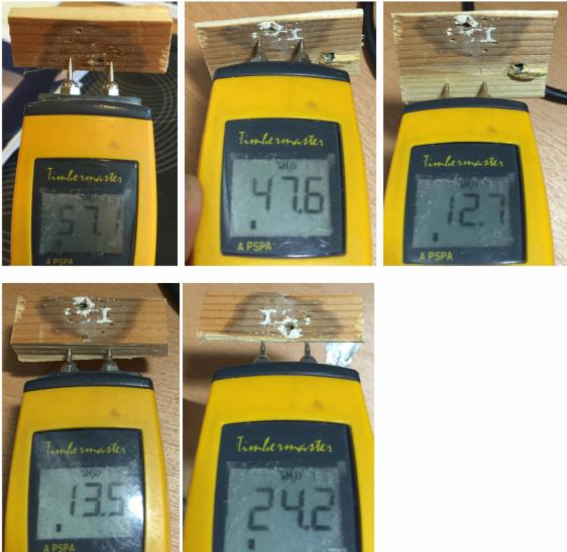
Figur 10 Fuktmätning med resistiv FK-givare ger ett högre värde vid mätning inom saltpåverkade områden än gravimetriska mätmetoder (13,8 % FK).
